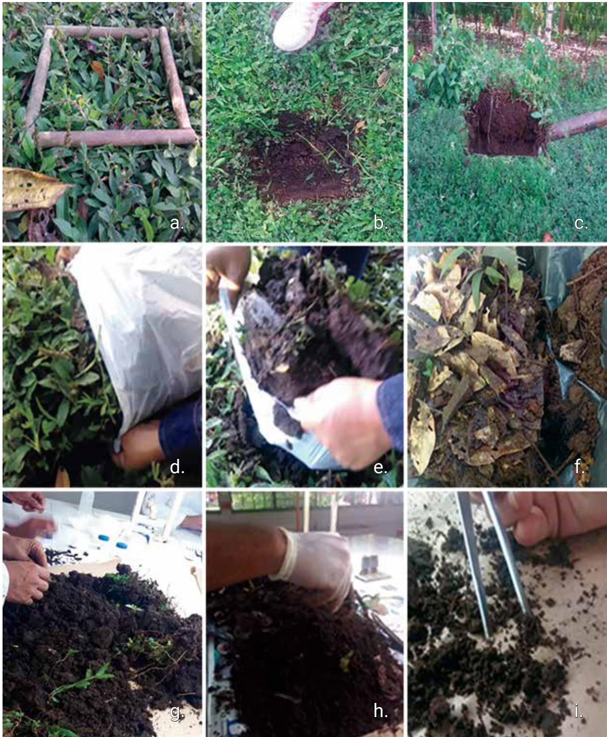
Figura 11. Metodología de colecta de las muestras de suelo en campo. a) Delimitación del suelo con un marco de 20 x 20 cm; b) Calicata de 20 x 20 cm con 20 cm de profundidad; c) Bloque de suelo, sin retirar la capa vegetal; d-e-f) Empacado en bolsas y rotulado de las muestras, sin retirar la hojarasca para traslado al laboratorio; g-h-i) Extracción de la macrofauna del suelo, de forma manual y directa con ayuda de pinzas entomológicas. Fotos: E. Vélez-Lopez (2015).
